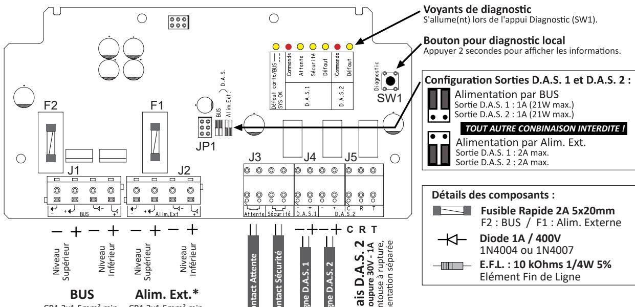
**BUS** CR1 2x1,5mm<sup>2</sup> min. **Alim. Ext.\*** CR1 2x1,5mm<sup>2</sup> min.
